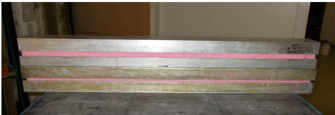
Bild 3 Foto der ausgeschäumten Einschubkassetten (erstellt vom ift Labor Bauakustik)
