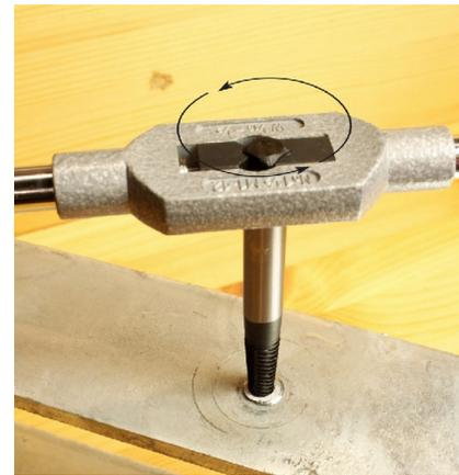
Das Windeisen wird nun am Schraubenausdreher montiert.
