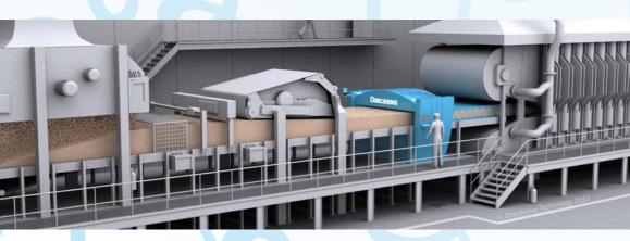
Implementierung von Dascanova Technology in einer kontinuierlichen Produktionslinie für Faserplatten
